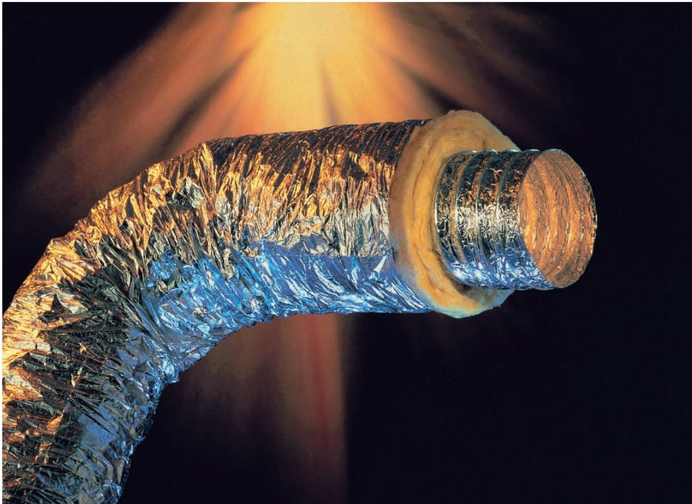
El tubo flexible **ISODEC 25** está formado por un tubo interior tipo **ALUDEC**, aislado con una manta de fibra de vidrio de 25 mm. de espesor y 16 kg/m<sup>3</sup> de densidad, recubierto exteriormente por una resistente lámina de aluminio y poliéster reforzada con hilos de fibra en espiral.
